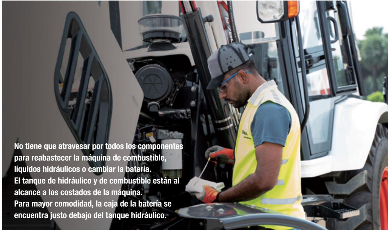
No tiene que atravesar por todos los componentes para reabastecer la máquina de combustible, líquidos hidráulicos o cambiar la batería. El tanque de hidráulico y de combustible están al alcance a los costados de la máquina. Para mayor comodidad, la caja de la batería se encuentra justo debajo del tanque hidráulico.
